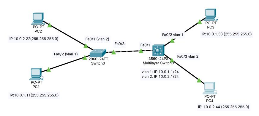
交换机2960除了接口Fa0/1,其它接口都是属于vlan 1,只有接口Fa0/1属于vlan 2,而三层交换机3560除了接口Fa0/3是属于vlan 2,其余的都属于vlan 1。现在在三层交换机3560上采用命令"ip routing"启用路由功能后,请问PC3能"ping"通那几台PC机?PC4能"ping"通PC2吗?它们属于同一vlan。PC4能"ping"通PC1吗?如果把交换机2960接口Fa0/3设置成trunk mode,情况又如何?注意这里设置vlan 1和vlan 2的IP地址时,要激活"no shutdown"!
