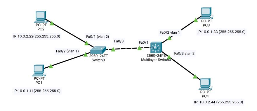
交换机2960除了接口Fa0/1是属于vlan 2,其它接口都属于vlan 1,而三层交换机3560除了接口Fa0/3是属于vlan 2,其余的都属于vlan 1。当交换机2960接口Fa0/3还没有配置成trunk mode,请问PC3能"ping"通那几台PC机?
