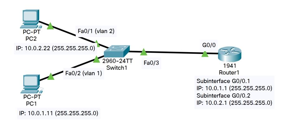
注意: 在给路由器的接口G0/0配置子接口之前,需要激活接口G0/0 ("no shutdown"),不然Packet Tracer中显示路由器连接交换机的连线两端还是红色的!在实体机上可能还会出现"ping"不通的现象。
